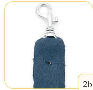
1- À l'aide du pic, faire un trou à l'endroit désiré au travers de la pièce à riveter.
